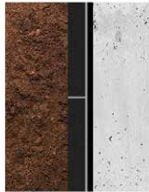
Sobre muro en contacto con terreno con impermeabilización
