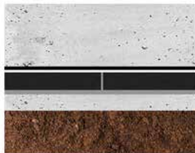
Sobre capa de hormigón de limpieza e impermeabilización de la losa de hormigón
