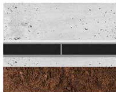
Sobre capa de hormigón de limpieza
