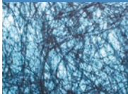
Estructura fibrosa lana mineral de vidrio
