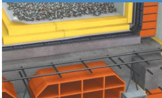
Cubiertas no transitables
