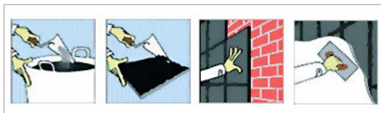
El aislamiento con vidrio celular “POLYDROS” en 2 cm. de espesor, equivale al de un muro de ladrillo macizo de 37,5 cm. de espesor.
